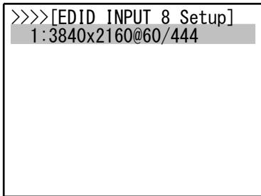
出力端子の EDID をコピーして使用するには、コピー元の出力端子を選択します。この時、出力端子につながった機器から正常に EDID が読み込めていないとコピーはできません。
