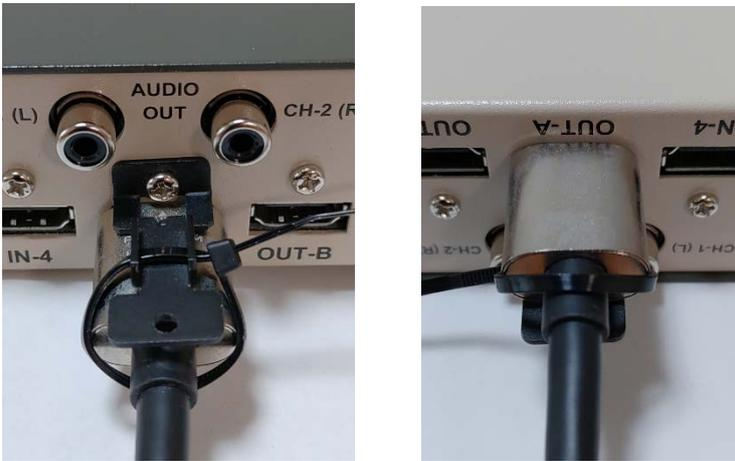
付属の CL-1 金具を予め本体へ取り付けます。取り付けネジは出荷時に、本体に実装済みです。(M3 ビス) HDMI プラグを挿入し、付属の束線バンドでプラグ後部を固定します。束線バンドの不要部分は切り取ってください。
