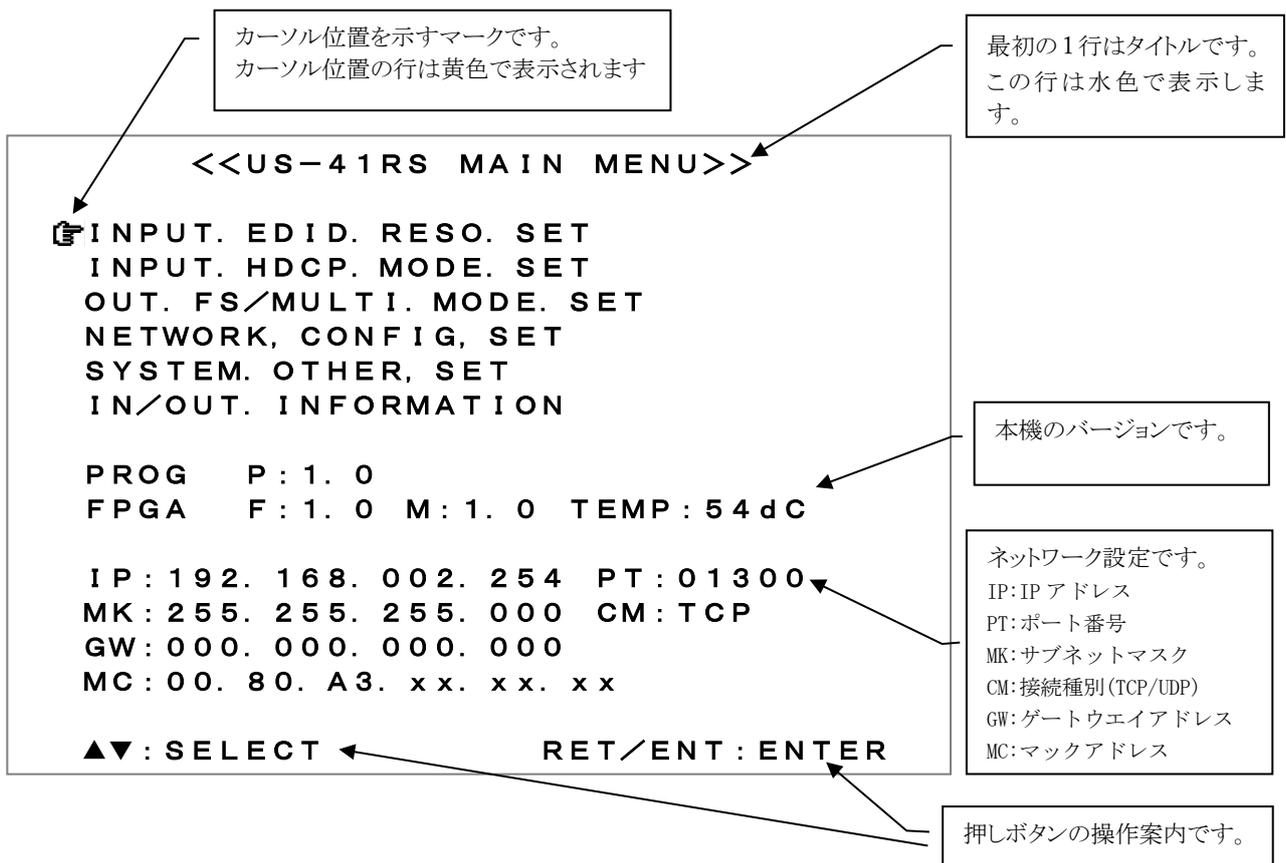
メインメニュー表示で調整したい項目に **☞** マークを **上** **下** 押しボタンで合わせ、**RET/ENT** 押しボタンを押します。
