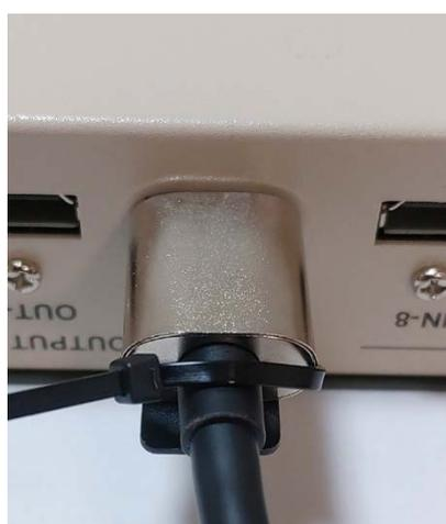
付属の CL-1 金具を予め本体へ取り付けます。取り付けネジは出荷時に、本体に実装済みです。(M3 ビス) HDMI プラグを挿入し、付属の束線バンドでプラグ後部を固定します。束線バンドの不要部分は切り取ってください。
