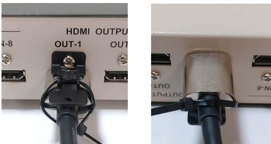
付属のCL-1金具を予め本体へ取り付けます。取り付けネジは出荷時に、本体に実装済みです。(M3 ビス)
